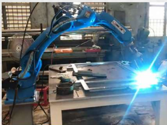
• 消防鐵箱焊接
