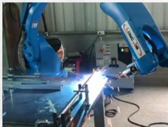
• 鍍鋅鋁管焊接
