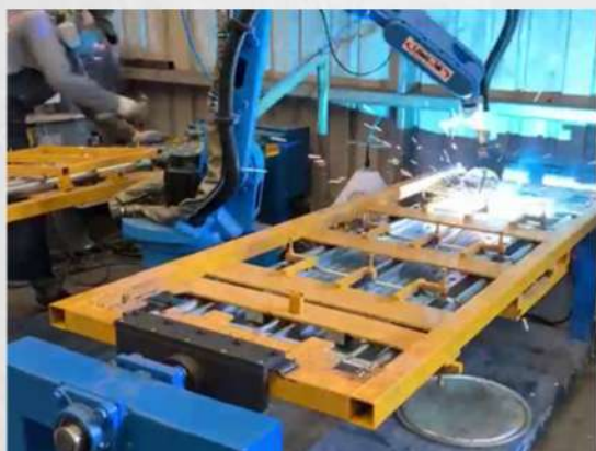
• 水平踏板焊接
