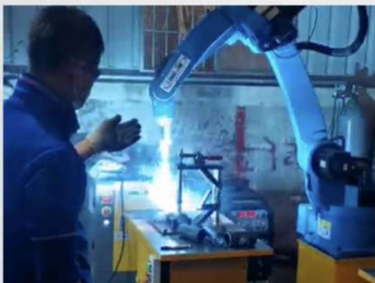
• 配管鋼管焊接
