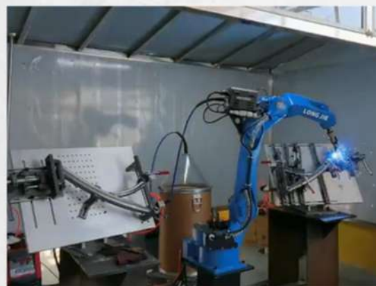
• 腳踏車體焊接
