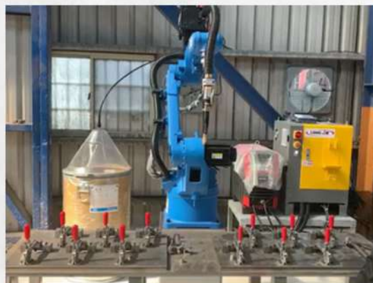
• 鷹架配件焊接
