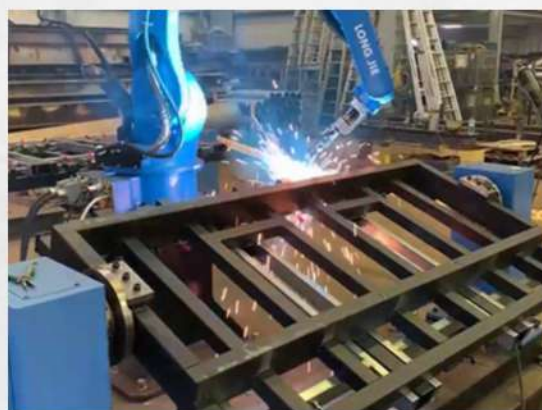
• 鋼構及桁架焊接
